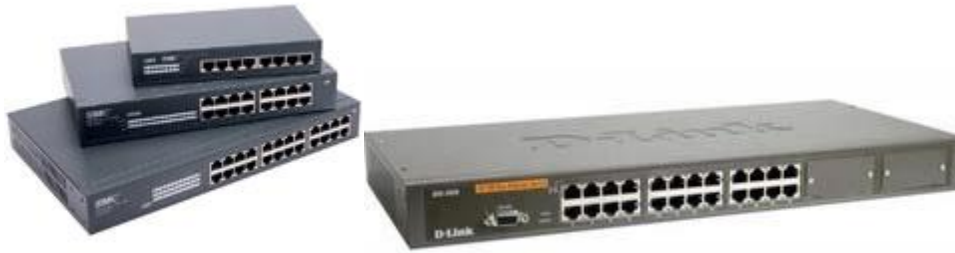
รูปที่ 2.4.7 Unmanaged Switch และ Managed Switch
