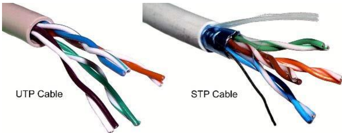
รูปที่ 2.1.3 สาย STP และ UTP
