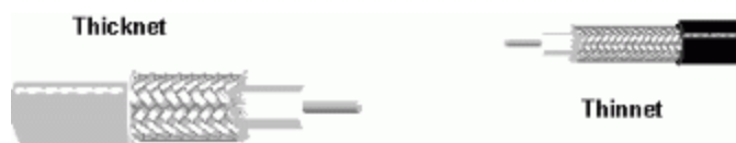
รูปที่ 2.2.6 การเปรียบเทียบสายโคแอกเชียล
